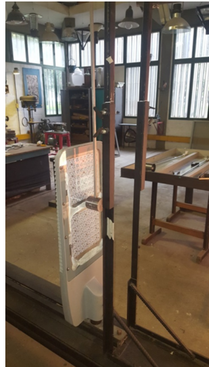
Fig. 13: martillo de pendulo para ensayo de IK en luminaria Vial
