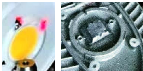
Fig. 4. Detalle del LED COB utilizado y su sistema de soporte el cual sirve para sujetarlo en la luminaria disipador.
