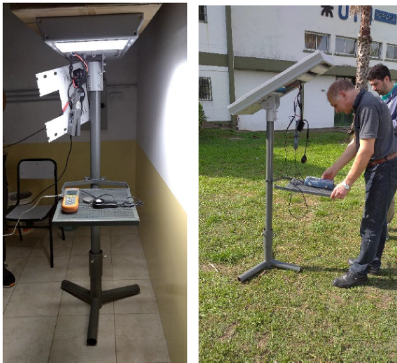
Fig. 10. Mediciones eléctricas, lumínicas y evaluación de la eficiencia de carga en función de la orientación al sol.
