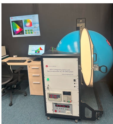
Fig.3: Instrumentación utilizada en el Laboratorio de Luminotecnia para la caracterización colorimétrica de las fuentes luminosas.
