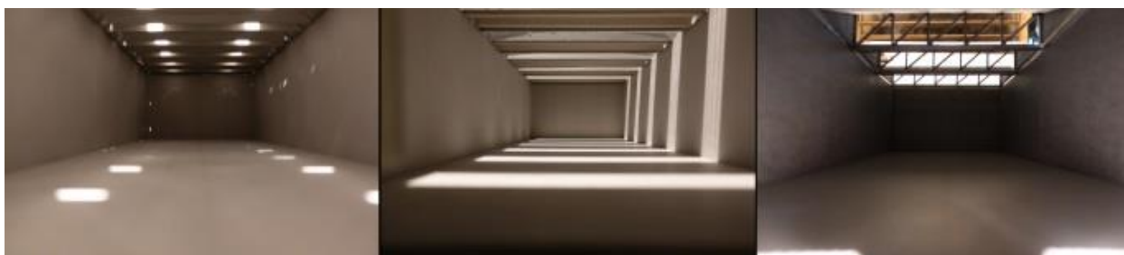
Fig. 6: Comparativa Heliodón para las tres configuraciones de cubierta
