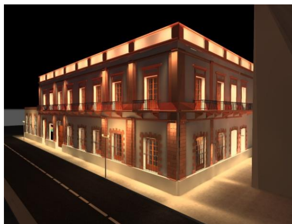
Fig. 3. Alternativa 2 iluminación coronamiento luminarias en posición vertical
