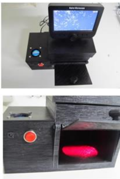
Fig. 6: Prototipo del sistema automático de captura para speckle dinámico.
