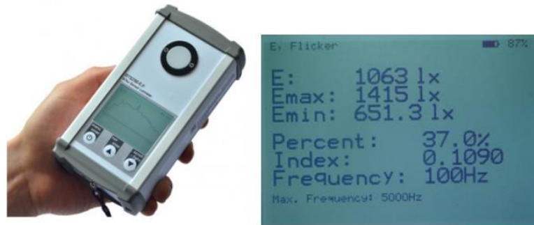
Fig. 2: Instrumento fabricado por Gigahertz-Optik para la medición y determinación de los contenidos de parpadeo.
