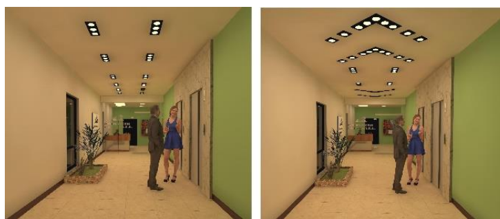
Fig. 1: Distribución lineal de luminarias en planta (izquierda) y con un arreglo que señala la dirección de circulación (derecha). En ambos casos las condiciones de iluminación son similares.
