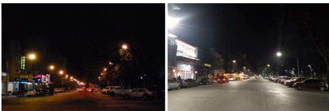
Fig. 6: Comparación de Calle Santiago del Estero 1100 (S.M de Tucumán) con luminarias de HPS a la izquierda y luminarias LED a la derecha
