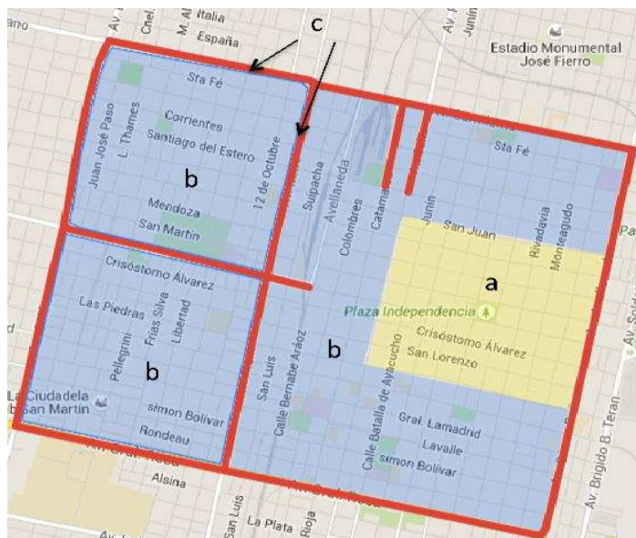
Fig. 2: Plano del área relevada. Clasificación de las vías de tránsito según su geometría.
