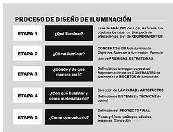
Figura 4 – Proceso de diseño de iluminación arquitectónica.
