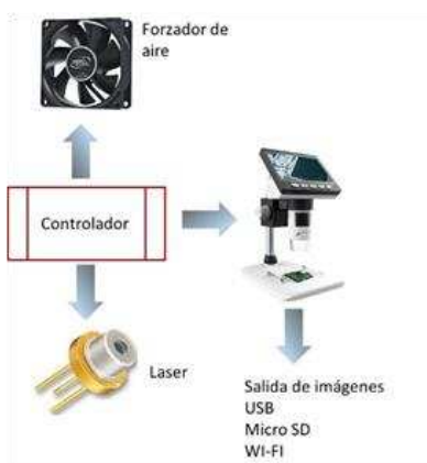
Fig. 4: Esquema en el que se muestra la disposición de los elementos para generar un sistema de de análisis microbiológico mediante speckle dinámico.
